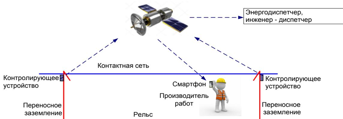
Рисунок 8 – Схема передачи информации о применении переносного заземляющего устройства с помощью контролирующего устройства с GPS-трекера (или ГЛОНАСС-трекера)
